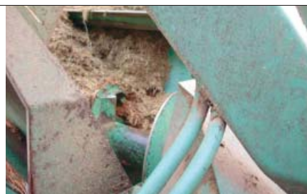
Zona posteriore del carro con accesso alle coclee libere, non protette. (Fonte: Regione Piemonte)
