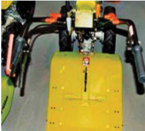
Protezione degli organi fresanti e comandi a uomo presente (frizione ad azionamento rovesciato). (Foto Di Martino)
