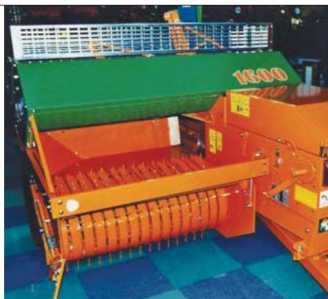
Raccogli imballatrice a balle parallelepipede. (Foto Di Martino)
