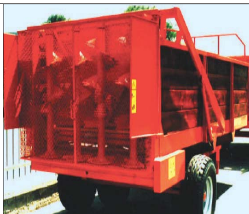
Carro spandiletame con protezione per la fase di trasporto sul campo. (Foto Di Martino)
