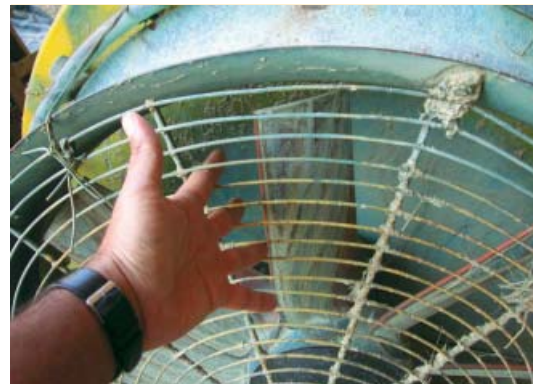
Ventola con protezione inadeguata. (Foto Di Martino)
