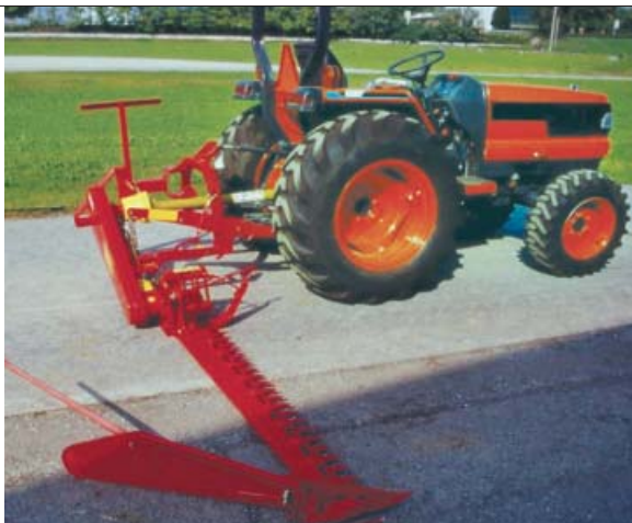
Falciatrice a lama e controlama alternative. (Foto Di Martino)
