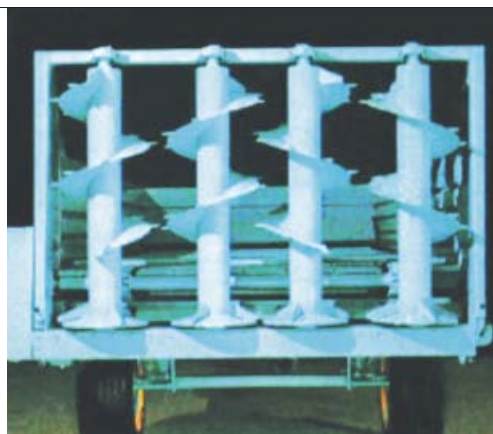
Carro spandiletame posteriore senza protezione. (Foto Di Martino)
