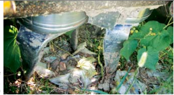
Erpice rotante senza protezioni. (Foto Di Martino)
