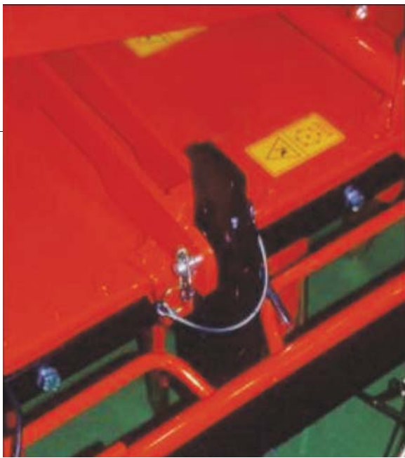
Erpice rotante con protezione. (Foto Di Martino)
