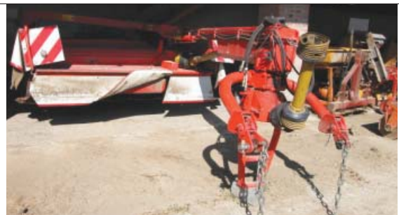
Falcia condizionatrice con rotori falcianti ad asse verticale e con protezioni in telo. (Foto Di Martino)
