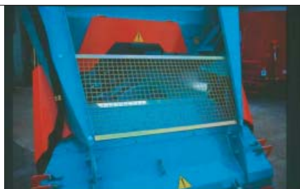
Zona posteriore del carro con accesso protetto alle coclee. (Fonte: Regione Piemonte)
